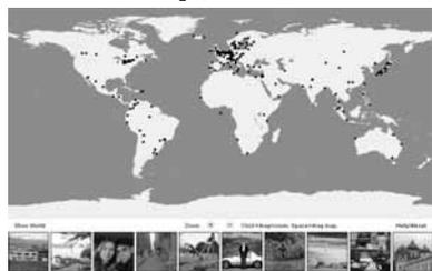
図 4 のページは、写真と位置情報を関連づけるリスト 1 の CGI プログラムで生成したものです。引数に時刻を指定して写真を取得し、地図とともに表示します。ここで地図をドラッグすると、時刻を示す ID と地図の中心の緯度経度を引数として、別の CGI プログラム (register.cgi) が呼び出され、その時刻と緯度経度を関連づけます。
