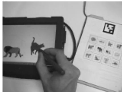
や絵の上にペンを移動してペンのボタンを押すと、データが(ペンに吸い込まれるように)表示から消えます(Pick 操作) そのペンを別の計算機の画面上に移動してペンのボタンを押すと、その計算機にデータが転送されて画面にデータが表示されます(Drop 操作) このように、Pick-and-Drop 手法を使うと、筆を使って弁当のおかずを交換するように異なる計算機間でデータをやりとりすることができます。
